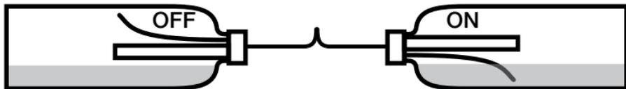
Brennstoff im Schlauch wird so verbrannt, und der Restdruck in der Brennstoffflasche entweicht. Die Flamme erlischt nicht sofort, sondern brennt abhängig vom verwendeten Brennstoff und von der Öffnung des Reglers noch einige Minuten.
